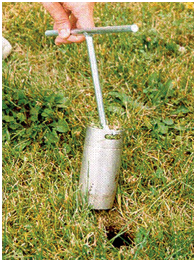
Obr. 2 Systém odberu pôdnych monolitov z trávnych porastov
