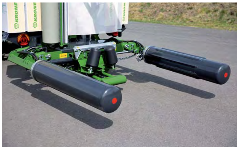
Dva velké hnané válce (vždy jeden hladký a jeden profilovaný) zajišťují spolehlivé otáčení balíku i v těžkých podmínkách
