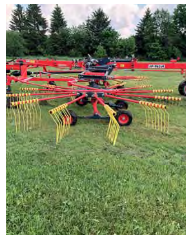
SP - 962H, 13 ramenné rotory o průměru 4,2 m, 4 dvojprsty na rameni
